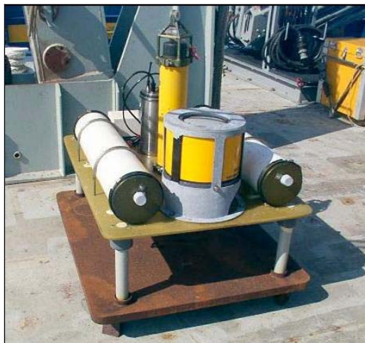
Figure 26. Plate-forme supportant le capteur de pression hydrostatique
