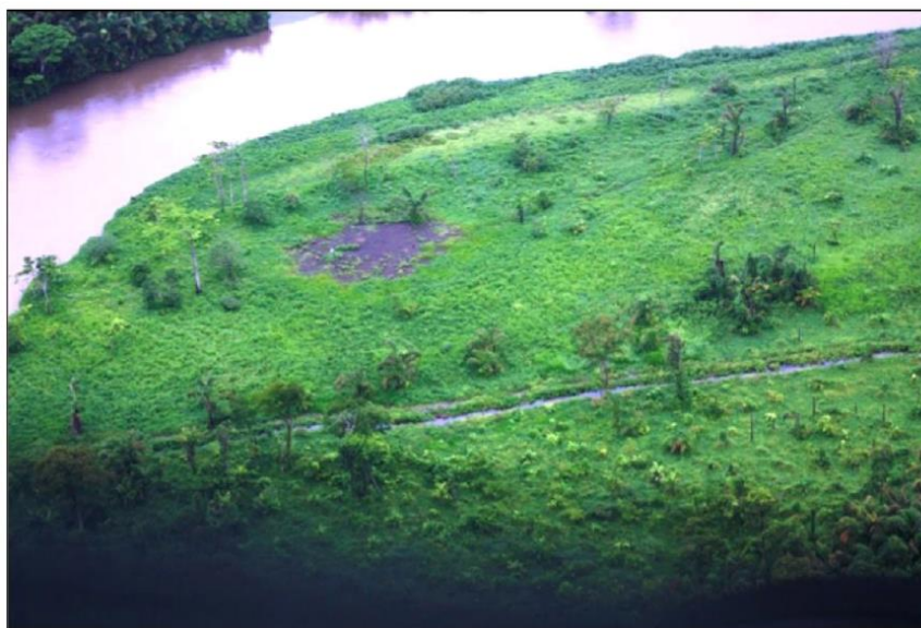
Figure I.39 : Photographie prise le 15 juin 2011 montrant le débit et la largeur réduits du caño , la végétation en train de recoloniser le chenal extérieur et les bermes et des poches de végétation en train de se former sur le talus formé de résidus de boues de dragage
