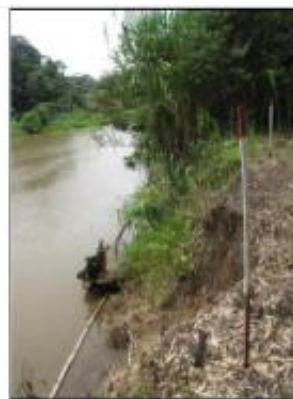
b) Rive droite (costa-ricienne) en recul au point Delta
