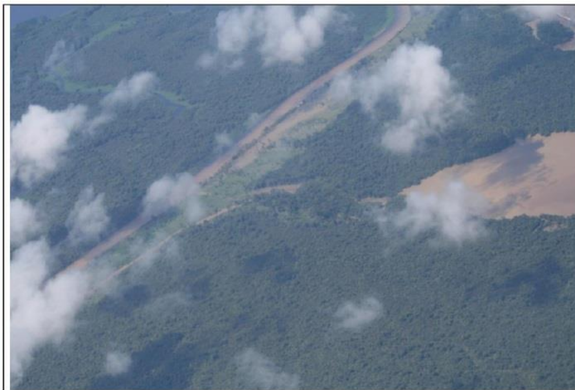
Figure 9.b. : Photographie aérienne prise le 5 décembre 2010 en période de crue du fleuve San Juan, montrant le transport d'une quantité considérable de sédiments et la liaison hydraulique directe créée entre le fleuve et la lagune de los Portillos, suite à l'ouverture du canal artificiel par le Nicaragua, qui entraîne le passage des sédiments du fleuve via le canal jusqu'à la lagune, modifiant ainsi la qualité de l'environnement
