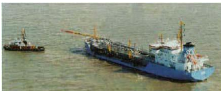
Drague à succion en marche, conçue pour décharger les déblais à travers des conduites.
