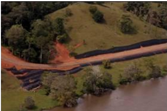
Figure 41 : point critique dû à l'écoulement de sédiments dans le fleuve
