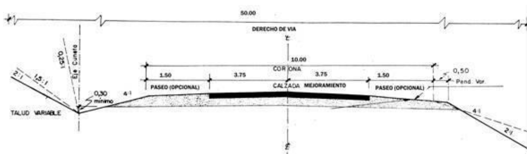
Figure 8 : section transversale avec une emprise de 50 mètres Source : données publiées relatives à la route pour illustrer l'emprise.
