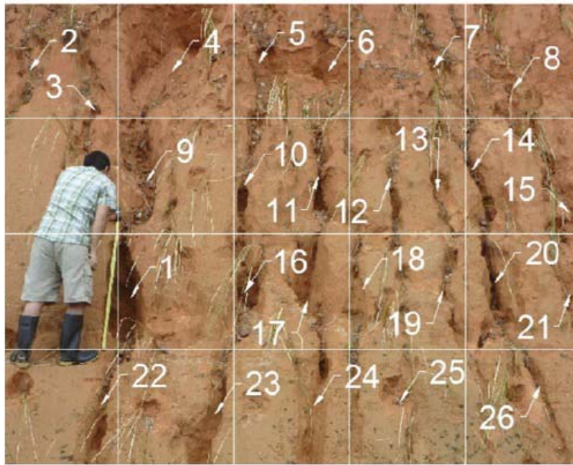
Figure 6. Site de surveillance de l'érosion en rigoles sur un talus de déblayage, avec rigoles numérotées et superposition d'une grille.
