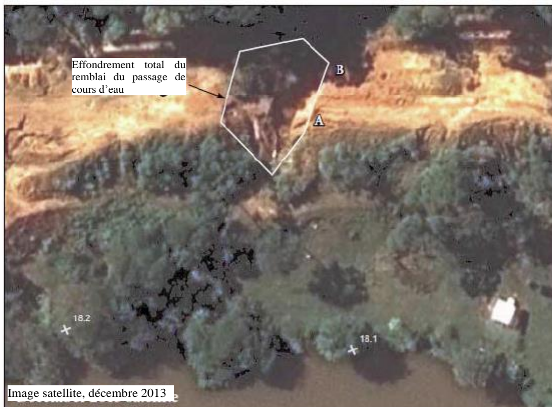
Figure 14 : Point d'érosion marquée n° 9.5, à 18,1 km en aval de la borne n° II. Image satellite à haute résolution de décembre 2013
