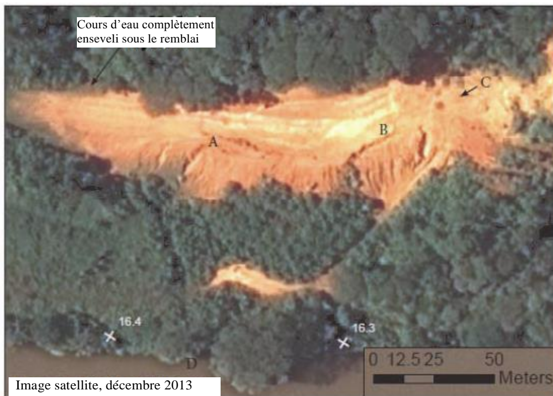
Figure 20 : Point d'érosion marquée n° 8.2, à 16,2 km en aval de la borne n° II. Image satellite à haute résolution de décembre 2013.
