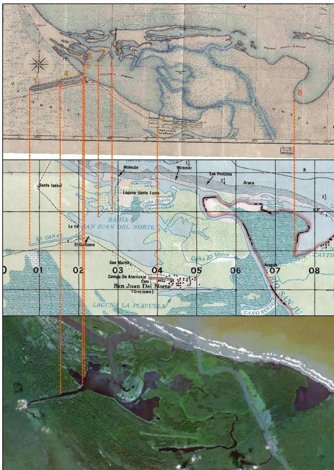
Figure 69 : Points d'appui au sol utilisés aux fins du géoréférencement de la carte du port de Greytown de 1899 (en haut) effectué à partir de la carte de San Juan del Norte de 1966 (au centre) et d'une image satellite de 2009 (en bas).
