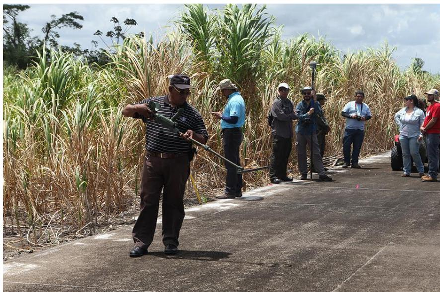
**Figure 12 : Examen de la piste d'atterrissage à l'aide du détecteur de métaux (VALLON modèle VMH3CS) fourni par le Nicaragua.**
