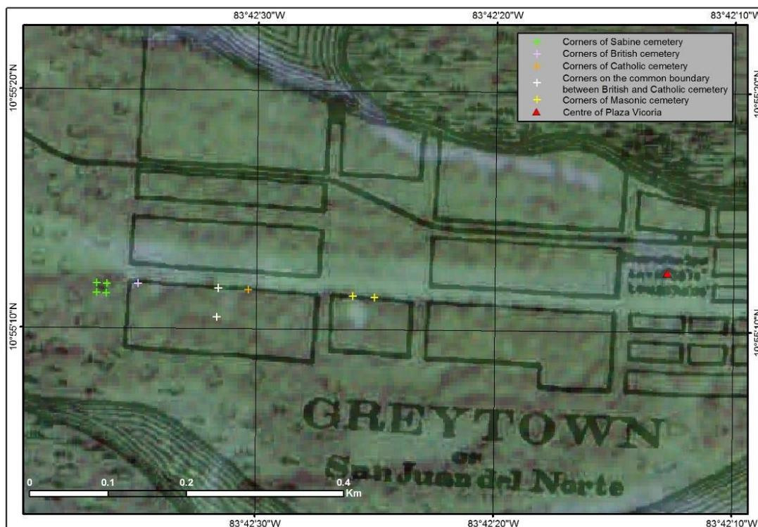
Figure 73 : Superposition du calque de la carte du port de Greytown de 1899 et de l'image satellite de 2009, faisant apparaître l'alignement des coins des cimetières ayant fait l'objet de relevés GPS par les Parties sur la lisière de la végétation haute, au sud de la piste d'atterrissage (agrandissement de la figure précédente).
