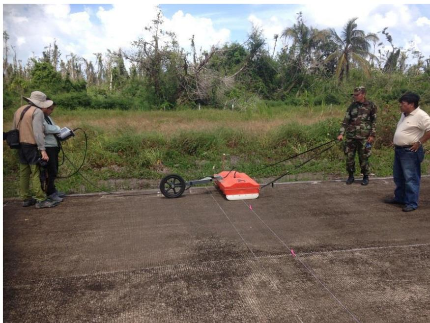
**Figure 11 : Obtention de profils par le Nicaragua à l'aide d'un géoradar GSSI équipé d'une antenne blindée de 200 MHz.**
