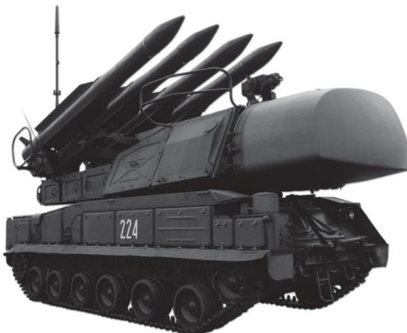
Figure 4 Tracteur-érecteur-lanceur radar autopropulsé (9A310M1) du Bouk-M1 SAM en position de tir 13
