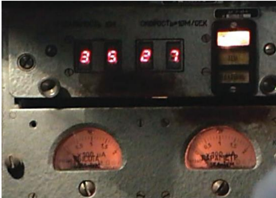
Figure 9 Indicateur numérique de la distance jusqu'à la cible (en haut à gauche) et de la vitesse (en haut à droite) et flèche indiquant l'altitude de la cible (en bas à gauche) et les paramètres de déplacement (en bas à droite) 30
