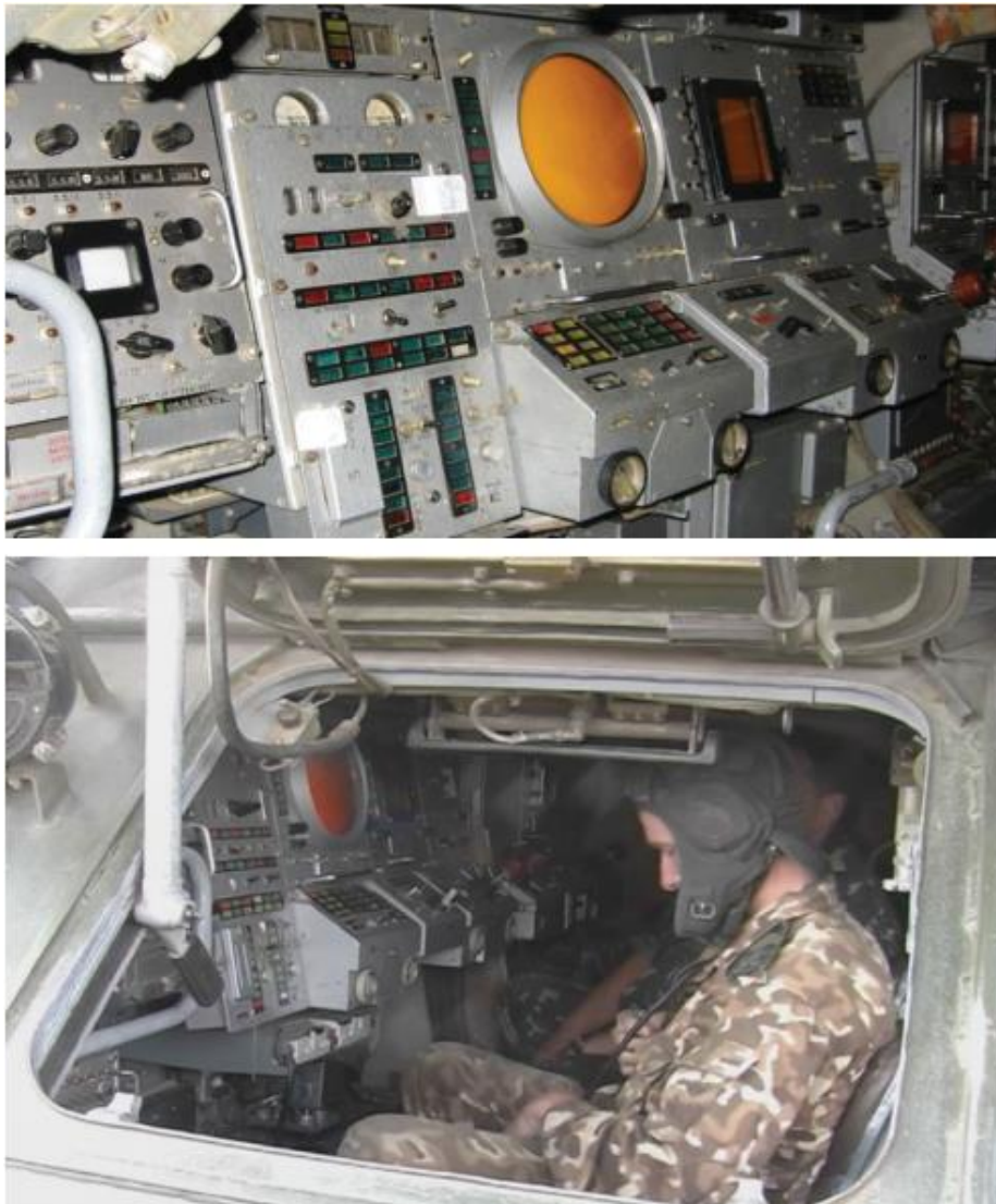
Figure 5 Postes de travail de l'équipage de combat du Bouk-M1 TELAR (9A310M1) 16
